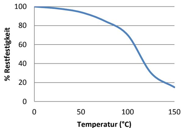
„Hitzebeständige“ Scherfestigkeitsversuche wurden auf Glas auf Weichstahl Klebeverbindungen durchgeführt. Vor den Testversuchen wurden die Teile über 30 Minuten auf der Testtemperatur gehalten. UV620 kann bei geringen Belastungen kurzzeitig auch höheren Temperaturen ausgesetzt werden (z.B. bei Einbrennlack- oder Schwall-Löt-Verfahren). Niedrigste Temperatur bei Endfestigkeit: -55°C (abhängig von den verwendeten Materialien).
